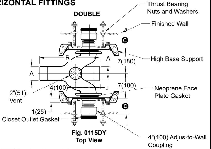
**Fig. 0115DY Top View**
