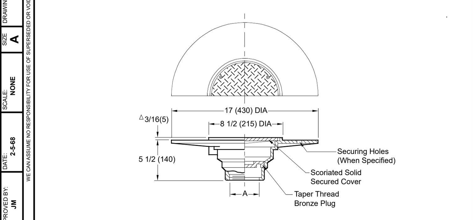
Fig. DX4343C . . . . . CAULK OUTLET
