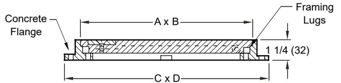
Fig. 4915 . . . . HINGED SECURED COVER
