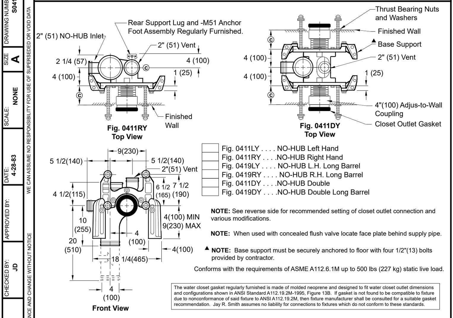
**© DIMENSION - ADJUS-TO-WALL TYPE OUTLET CONNECTION**
