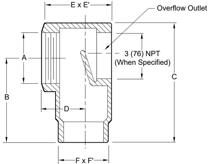
Fig. 1550T . . . . . DOWNSPOUT ADAPTOR
